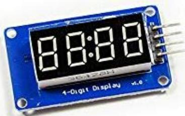
Das Display wird, neben den üblichen +5V und GND für die Spannungsversorgung, an die Arduino Pins 12 (Data) und 13 (Clock) angeschlossen. Das sind beim ATmega die Pins PB4 (18) für Data und PB5 (19) für Clock.
