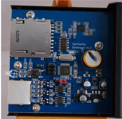
Zusätzlich bekommt der Logger einen eigenen Bootloader, sodass später im Bootseinsatz die Firmware per SD-Karte upgedatet werden kann.
