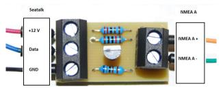
Legen Sie den Baustein, so wie auf dem o.g. Bild vor sich. Auf der linken Seite befindet sich nun der Seatalk-Anschluss. Auf der rechten Seite wird der Logger angeschlossen.
